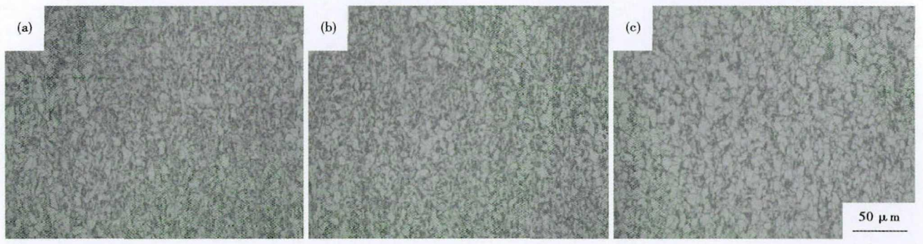
图2 L450M 钢 1#(a) 1/4;(b) 1/2;(c) 3/4 纵截面光学显微组织
